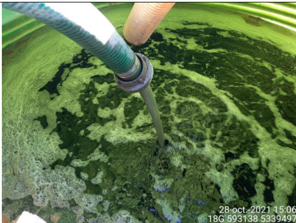
Fotografía N°10: Retiro de Lixiviados a estanque de acumulación. Tomada: Jueves 28 de Octubre del 2021
